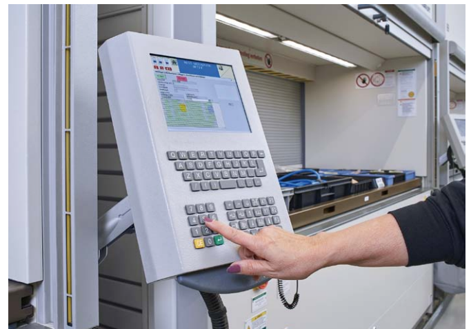
Grafische Darstellung des Lagerplatzes direkt an der Hänel Steuerung MP 12 N im SAP-Template.
