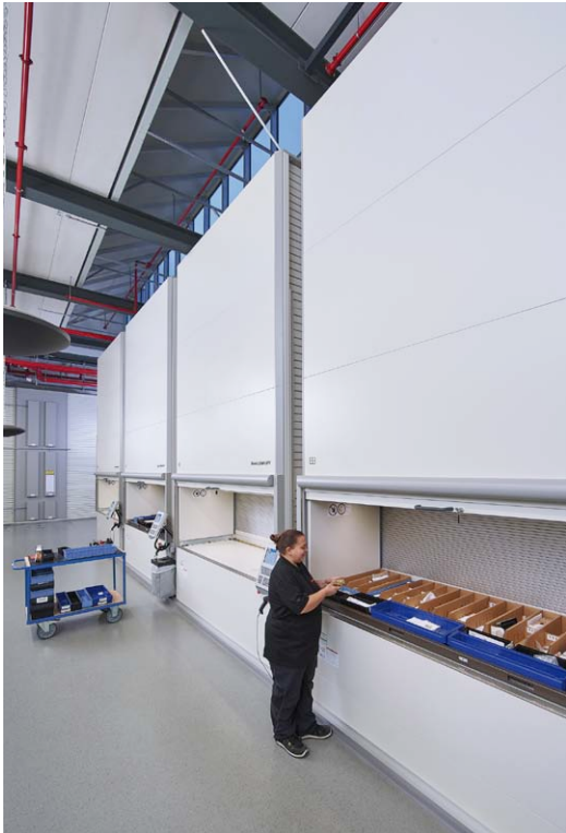
Für beide Produktionsebenen werden SAP-gesteuerte Aufträge an den Lean-Liften zusammengestellt.
