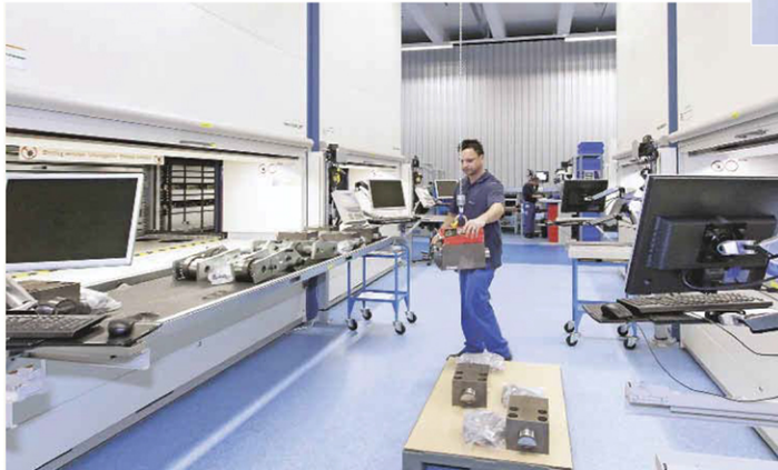
An der Entnahmestelle der Lean-Lifte ist jeweils ein Viad@t-Terminal installiert, mit dem die Buchungen erfasst werden. Bilder: Gerd Knehr
