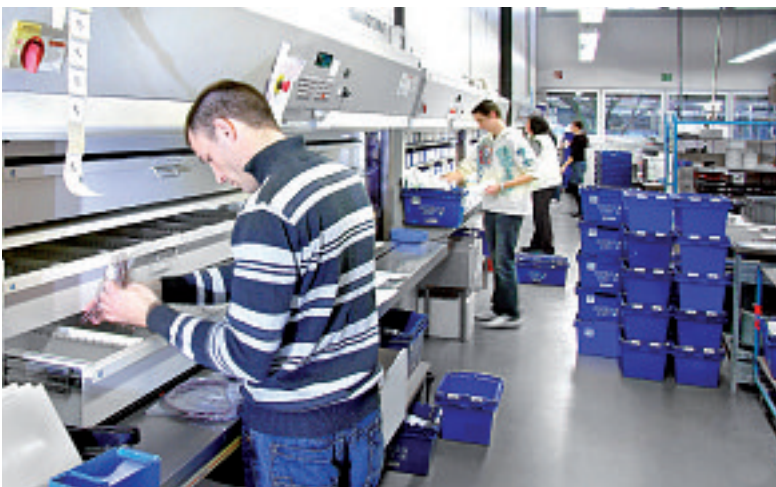
Der Pick-by-Light-Kommissionierautomat im Zusammenspiel mit den Lean-Liften von Hänel.
